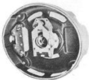
Fig. 1.5. — Aspecto interior de un escudo de motor monofásico mostrando la parte fija del interruptor centrífugo (Wagner Electric Company).
