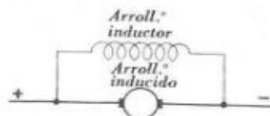
Fig. 7.12. — Conexión de los arrollamientos inductor e inducido en un motor derivación.
