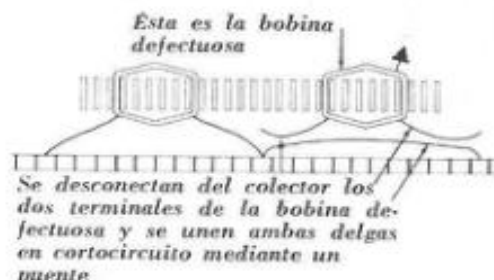
Fig. 6.74. — Manera de dejar fuera de servicio una bobina con contacto a masa en un arrollamiento ondulado.
