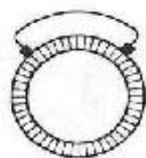
Fig. 3.11.—Dos escobillas pueden bastar en un motor tetrapolar si el arrollamiento del inducido es ondulado o si el colector está provisto de conexiones equipotenciales.
