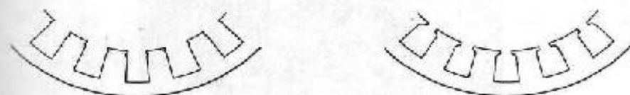
Fig. 4.9. — A) Esquema desarrollado de un grupo de tres bobinas individuales conectadas en serie y alojadas en sus respectivas ranuras; B) esquema de una de tales bobinas individuales, retirada del estator para utilizarla como modelo de las demás.
