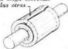
Fig. 6.111. — Delga saliente en un colector.
