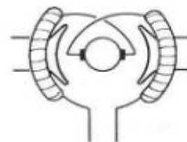
Fig. 9.17. — El mismo motor de la figura 9.16, pero con los terminales del inducido invertidos. El motor girará ahora en sentido antihorario.
