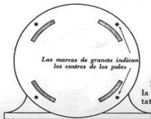
Fig. 3.19. — Esquema circular del arrollamiento estatístico de un motor octapolar para dos tensiones de servicio.
