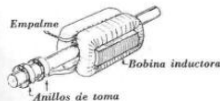
Fig. 10.32. — Rotor de un sincronizador.
