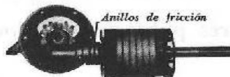
Fig. 4.4. — Rotor bobinado y escudo de cojinete de un motor trifásico (Wagner Electric Company).
