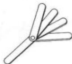
Fig. 4.131. — Calibre para entrehierros. Se compone de varias láminas metálicas de diferentes espesores.
