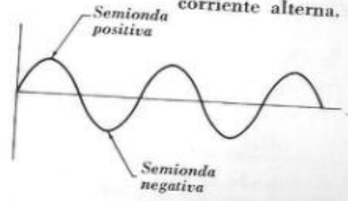
Fig. 11.14. — Ondas de corriente alterna antes de ser rectificadas.
