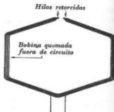
Fig. 4.138. — Una vez cortadas las espiras, los hilos sueltos se retuercen sobre sí mismos a uno y otro lado del corte.
