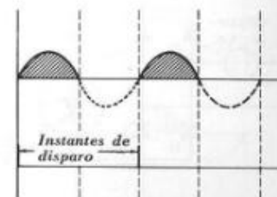
Fig. 11.49. — Aplicación de los impulsos con un ángulo de fase de 0° eléctricos. El tiristor se ceba al principio de cada semiperíodo positivo.
