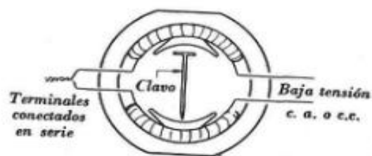
Fig. 9.12. — Prueba de polaridad. Si una vez excitadas ambas bobinas el clavo se mantiene en la posición indicada, las polaridades de éstas son correctas.
