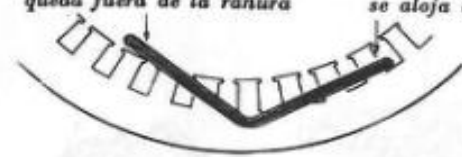
Fig. 4.24. — Disposición inicial de las bobinas en el estator.
