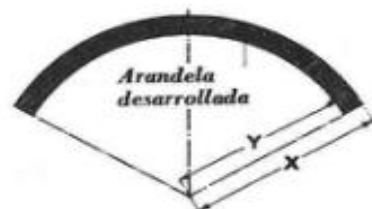
Fig. 6.105. — Contorno de una arandela desarrollada sobre un plano, completado hasta formar un sector circular.
