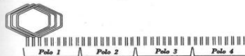
Fig. 4.33. — Esquema simplificado de las bobinas estáticas de un motor trifásico tetrapolar con 9 bobinas por polo.
