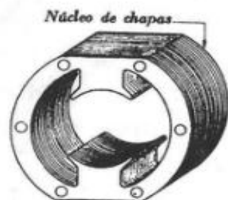
Fig. 9.3. — Núcleo estático de un motor universal bipolar.
