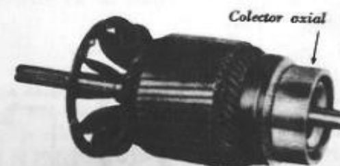
Fig. 3.3. — Inducido de un motor de repulsión e inducción. El colector es de tipo axial (delgas paralelas al eje) (Wagner Electric Company).
