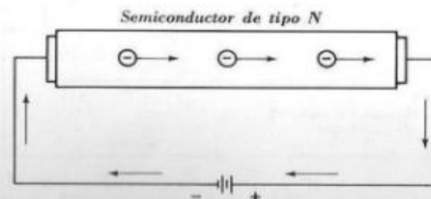
Fig. 11.3. — Desplazamiento de electrones libres en un semiconductor de tipo N.
