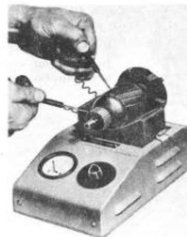
Fig. 6.77. — Bobina de prueba con su núcleo, terminales de ensayo y milivoltímetro reunidos en un solo aparato. Sirve para detectar y localizar cortocircuitos, interrupciones o contactos a masa en inducidos (Crown Industrial Products).
