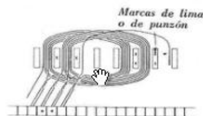
Fig. 6.43. — Esquema circular del arrollamiento ondulado retrógrado representado en la figura 6.41.
