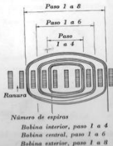
Fig. 1.18. — Pasos de las tres bobinas que forman un polo.
