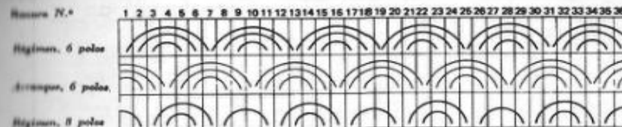
Fig. 2.49. — Diagrama típico de pasos de bobina en un motor con condensador de arranque, previsto para dos velocidades de régimen.
