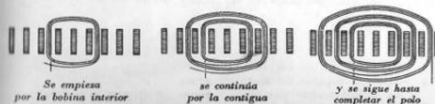
Fig. 1.28. — Manera de bobinar a mano un polo de un estator.
