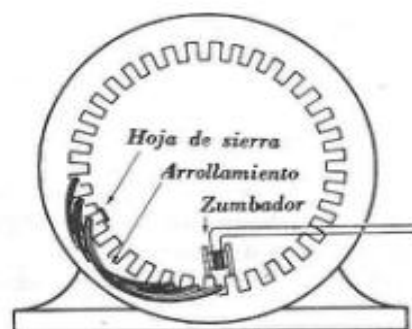
Fig. 4.123. — Localización de un cortocircuito entre espiras por medio de una bobina de prueba y una hoja de sierra. Ambas se desplazan por el interior del estator.
