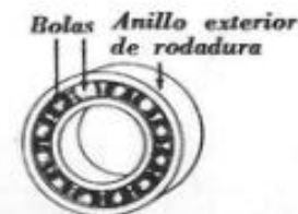
Fig. 7.9. — Cojinete de bolas. A la derecha, suelto; a la izquierda, montado en un escudo.
