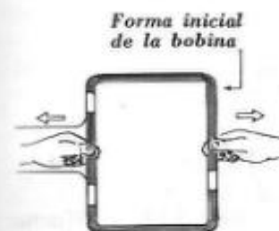
Fig. 4.16. — Las bobinas de motores pequeños pueden confeccionarse inicialmente de forma rectangular y transformarse después en hexagonales tirando por el centro de los dos lados mayores.
