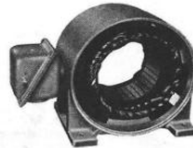
Fig. 4.2. — Estator de un motor trifásico ( Wagner Electric Company ).
