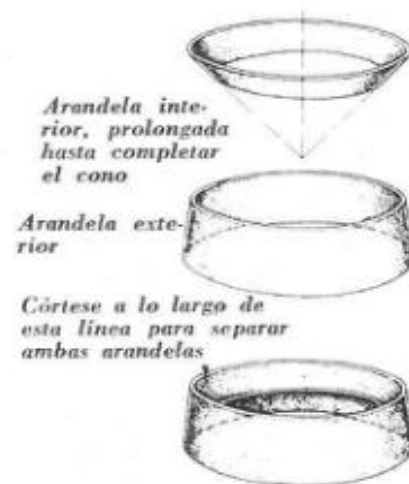
Fig. 6.102. — La arandela en V de mica se compone realmente de dos: una interior y otra exterior.
