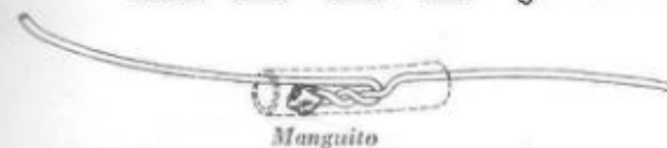
Fig. 1.54. — Empalme soldado con lámpara y aislado con un manguito.
