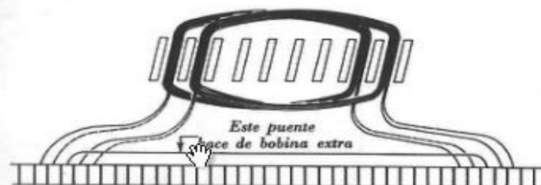
Fig. 3.41. — Arrollamiento ondulado con una bobina suplementaria en forma de puente de conexión. Es preciso recurrir a tal solución cuando el número de bobinas es par y el número de delgas lo excede en una unidad.
