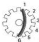
Fig. 9.21. — Vista de un inducido por el lado opuesto al colector, para determinar el paso de las bobinas.
