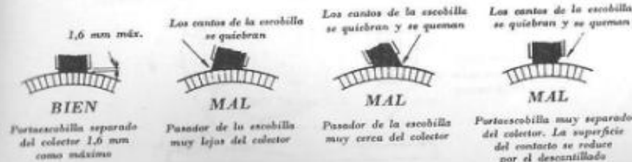
Fig. 7.62. — Posiciones correctas e incorrectas de las escobillas.
