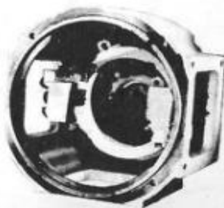
Fig. 7.6. — Escudo de un motor de corriente continua. Se aprecia claramente el puente de los portaescobillas (General Electric Co.).
