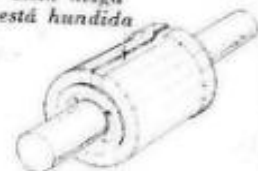
Fig. 6.112. — Delga hundida en un colector.
