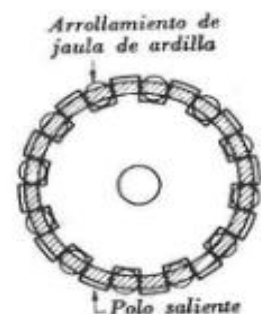
Fig. 10.24. — Estator provisto de polos con espira auxiliar, destinado a un motor síncrono para accionar un reloj eléctrico.
