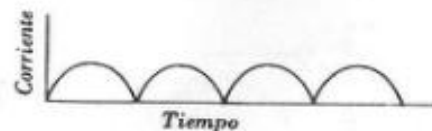
Fig. 10.45. — Corriente unidireccional pulsatoria suministrada por un rectificador de onda completa.
