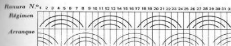
Fig. 1.19. — Manera de anotar los pasos de las bobinas en un motor de 4 polos y 32 ranuras. Si así se desea, puede indicarse también el número de espiras de cada bobina junto a la misma.
