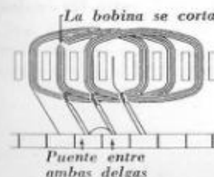
Fig. 6.78. — Detección y localización de cortocircuitos en un inducido mediante un milivoltímetro. Cuando el instrumento acusa una desviación nula o inferior a la normal, hay una bobina con cortocircuito.
