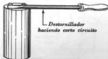
Fig. 2.80. — Prueba de un condensador. 2.ª operación: desconéctese el condensador de la red y cortocircuitense sus bornes con un destornillador. Debe observarse una chispa.
