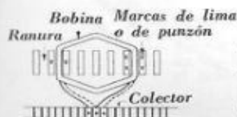
Fig. 6.45. — Manera de marcar el núcleo y las delgas para fijar el paso de cada bobina y la conexión de sus terminales al colector, en un arrollamiento imbricado.
