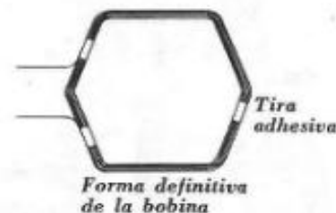
Fig. 4.16. — Las bobinas de motores pequeños pueden confeccionarse inicialmente de forma rectangular y transformarse después en hexagonales tirando por el centro de los dos lados mayores.
