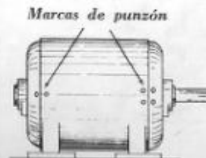
Fig. 1.15. — Los escudos y la carcasa se marcan con un punzón antes de desmontar el motor.
