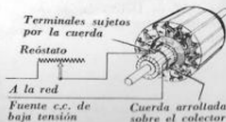
Fig. 6.61. — Localización de una bobina con contacto a masa mediante un milivoltímetro. Con auxilio del reóstato se regula la intensidad de la corriente hasta que el instrumento da una desviación normal.
