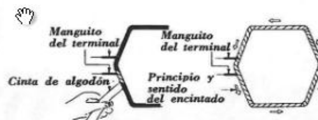
Fig. 4.22. — Manera de encintar una bobina prevista para alojar en ranuras abiertas.
