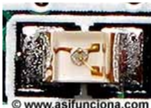
Figura 7: LED tipo "SMD" (Surface Mount Device – Dispositivo de montaje superficial), en esta foto extremadamente ampliado, montado sobre una tarjeta de un circuito impreso. Este dispositivo específico es del tipo agrupado por estar integrado por dos LEDs dentro de una misma cápsula y emiten luz de dos o tres colores diferentes. Su tamaño es de unos 3 mm aproximadamente.
