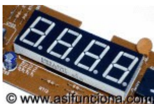
figura 8: Display de matriz de diodos numérica, muy utilizada para mostrar la frecuencia sintonizada en los radorreceptores o mostrar la hora en los relojes digitales.
