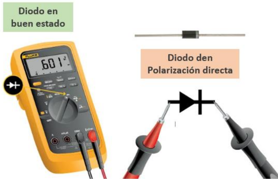
Prueba de diodo en polarización directa
