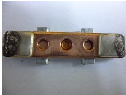
Contactos sobrecalentados por arcos eléctricos
