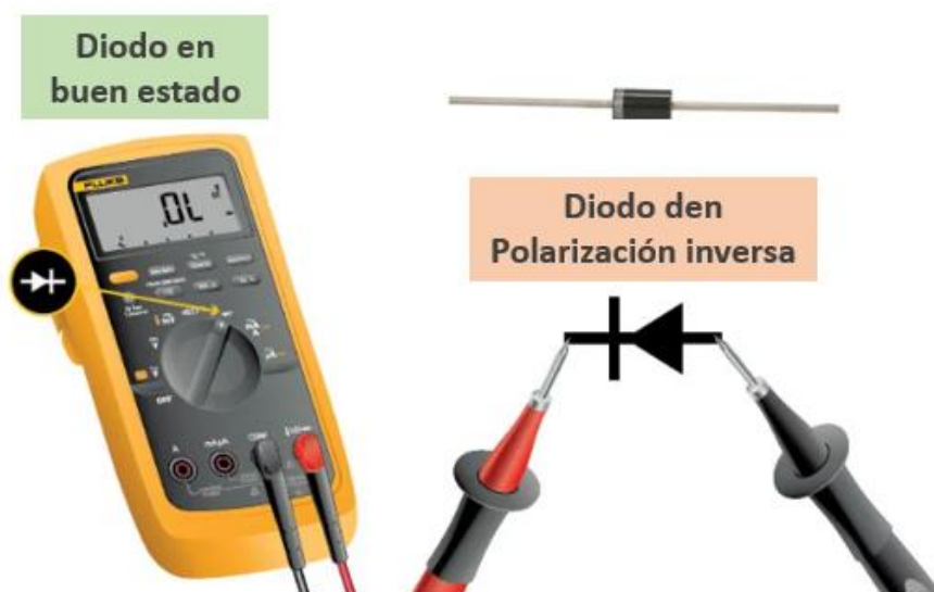
Prueba de diodo en polarización inversa
