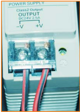
Figura 10.152. El led de la fuente de alimentación es un indicador de que la alimentación está correcta.
