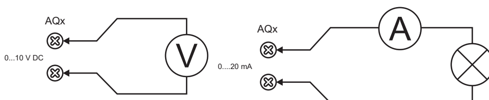
Figura 10.157. Comprobar tensión o intensidad en la salida analógica.
