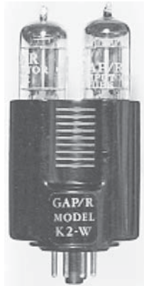
Figura 30. Primer amplificador operacional comercial no integrado GAP/R K2-W.
