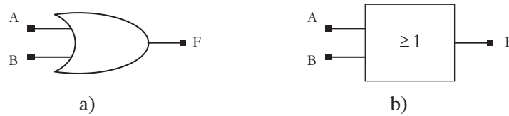
Figura 5. Símbolo de la compuerta lógica OR. a) Norma ANSI, b) Norma IEEE.
