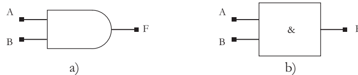
Figura 1. Símbolo de la compuerta lógica AND. a) Norma ANSI, b) Norma IEEE.
