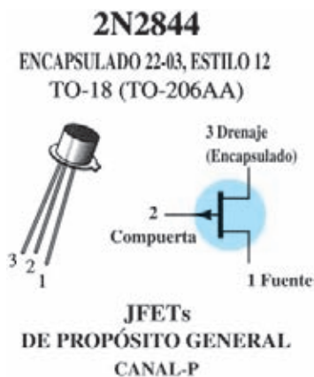
Figura 5.21 Encapsulado de “sombbrero de copa” e identificación de terminales para un JFET de canal- p .
