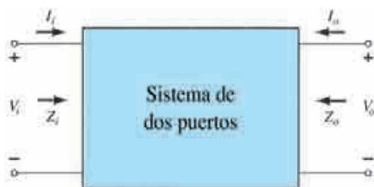
Figura 7.6 Sistema de dos puertos.
