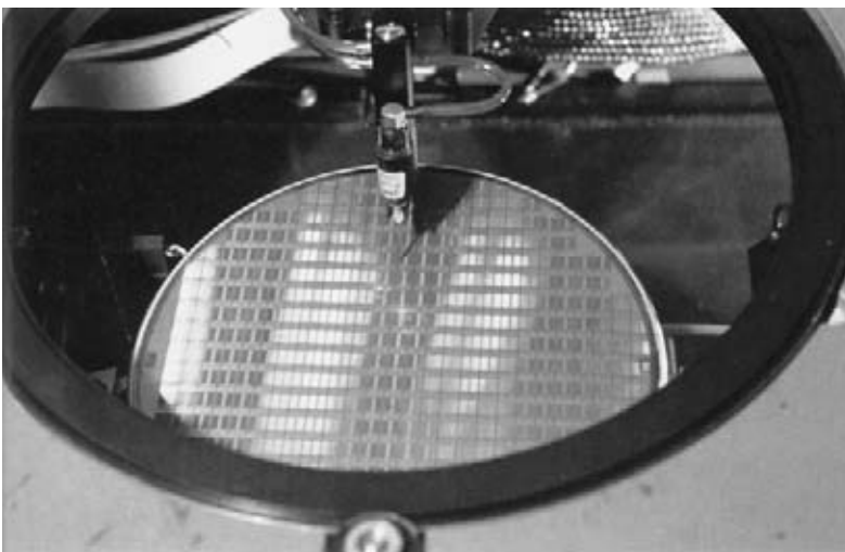
Los circuitos integrados individuales de memorias que se identificaron como defectuosos se marcan con un punto negro para ser desechados.
