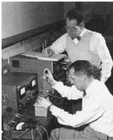
Los doctores Ian Munro Ross (al frente) y G. C. Dacey desarrollaron un proceso experimental para medir las características de los transistores de efecto de campo en 1955. (Cortesía de los archivos de AT&T.)
