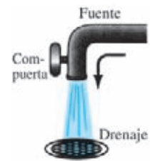
Figura 5.3 Analogía de agua para el mecanismo de control del JFET.
