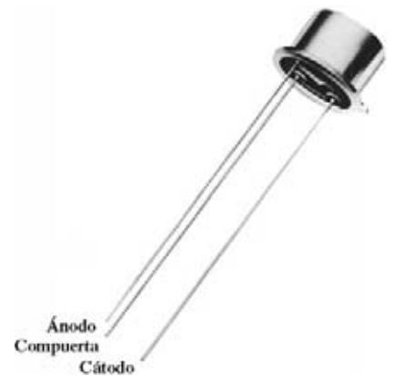
Figura 20.22 GTO típico y su identificación de terminales. (Cortesía de General Electric Company.)
