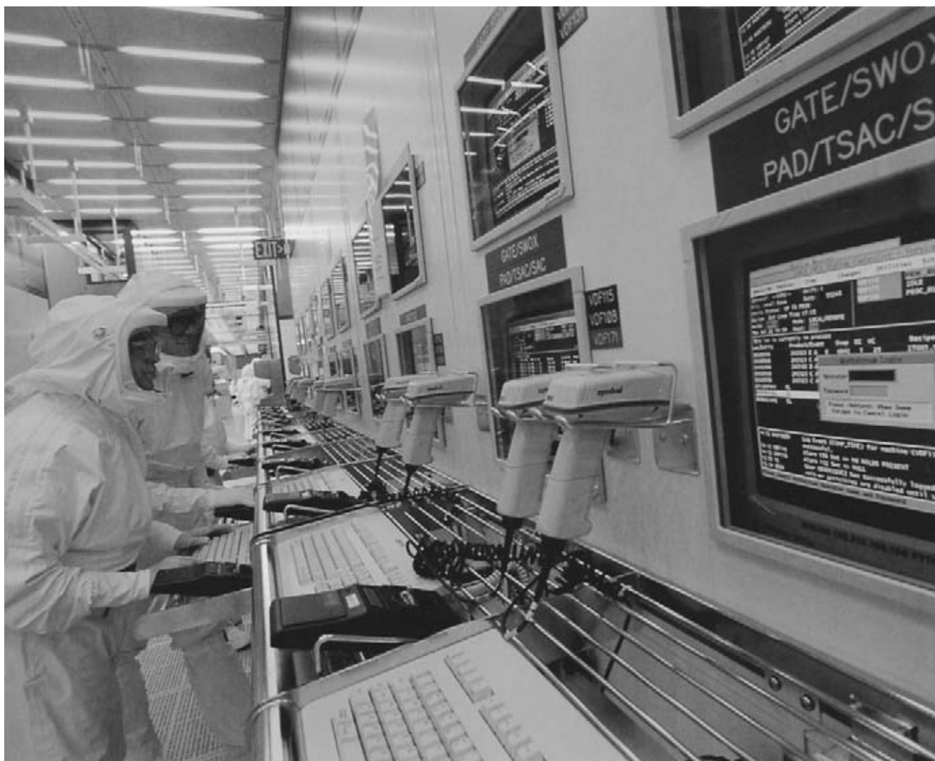
Trabajadores monitorean el horno en el que una capa de dióxido de silicio se añade a las obleas. Las “pistolas” leen el código de barras sobre las barcas.
