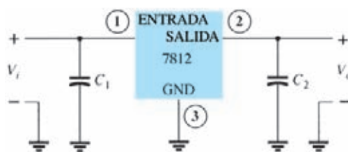
Figura 18.26 Conexión del regulador de voltaje 7812.
