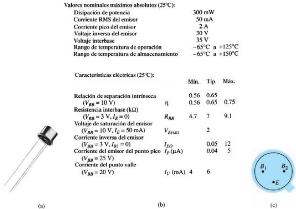
Figura 20.40 UJT: (a) apariencia; (b) hoja de especificaciones; (c) identificación de terminales. (Cortesía de General Electric Company.)
