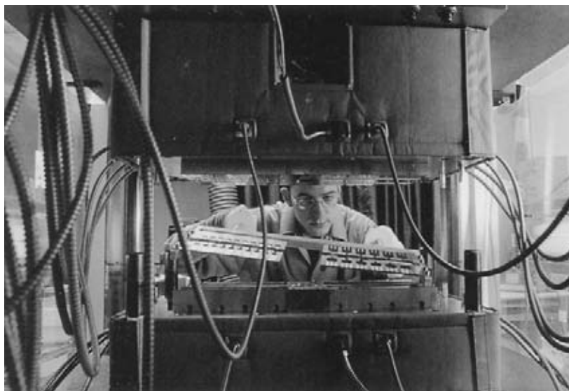
En las instalaciones de Intel de Chandler, Arizona, Jonathan McFarland opera una prensa que encapsula los circuitos integrados en un compuesto epóxico para protegerlos del ambiente.
