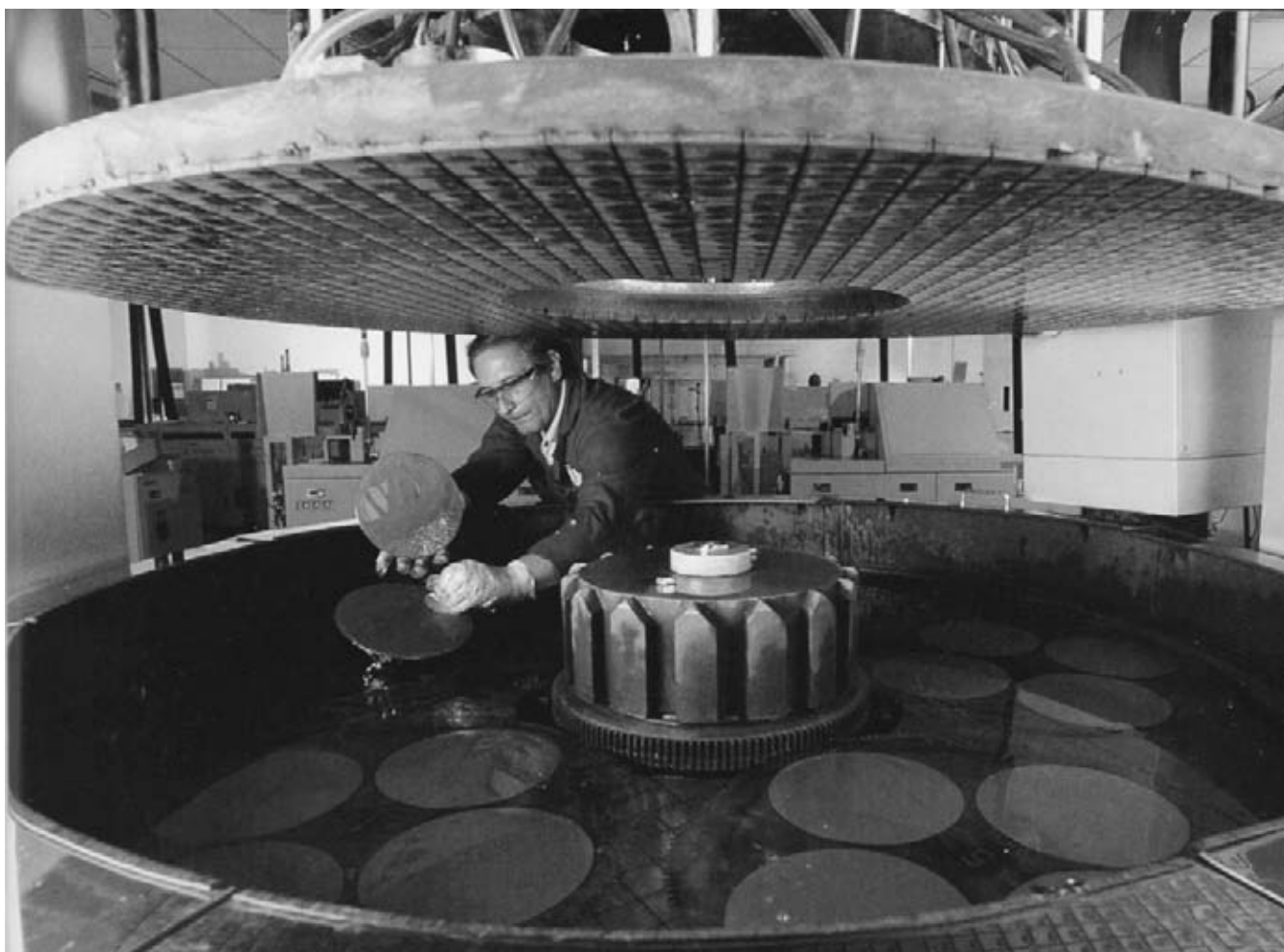
John Hallam coloca obleas en una máquina que las pulirá hasta lograr tolerancias extraordinariamente exactas.
