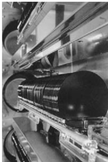
Obleas rebanadas de un cristal cilíndrico esferan en “barcas” de cuarzo para ser examinadas en busca de posibles defectos.
