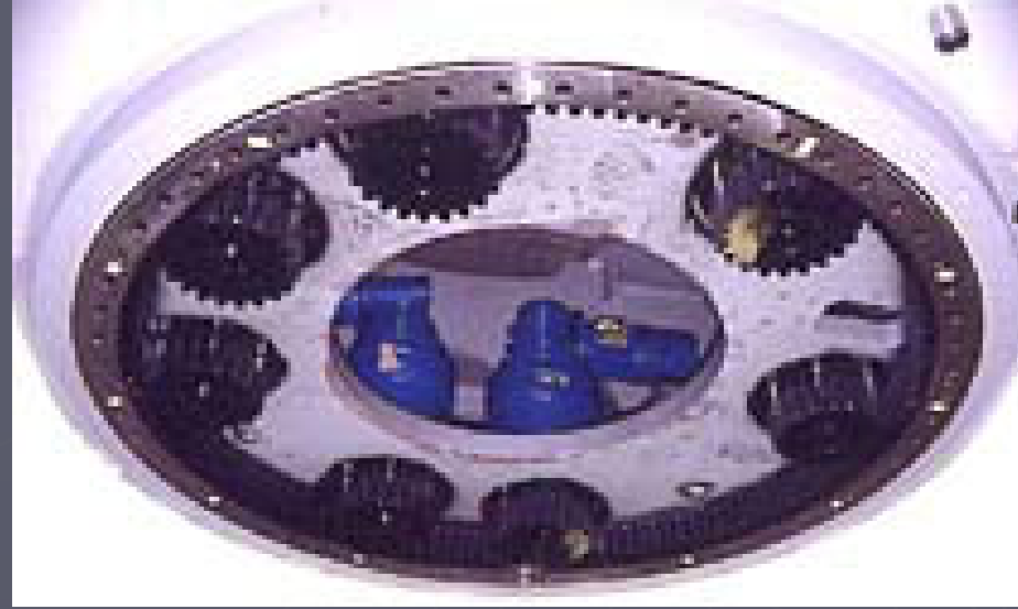
Mecanismo de orientación de una máquina típica de 750 kW vista desde abajo, mirando hacia la góndola
