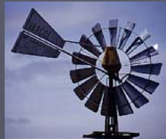
Molino multipala americano para bombeo de agua
