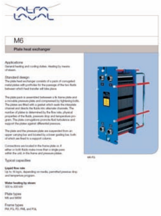
Figura 9.17. Ficha técnica del intercambiador (I).
