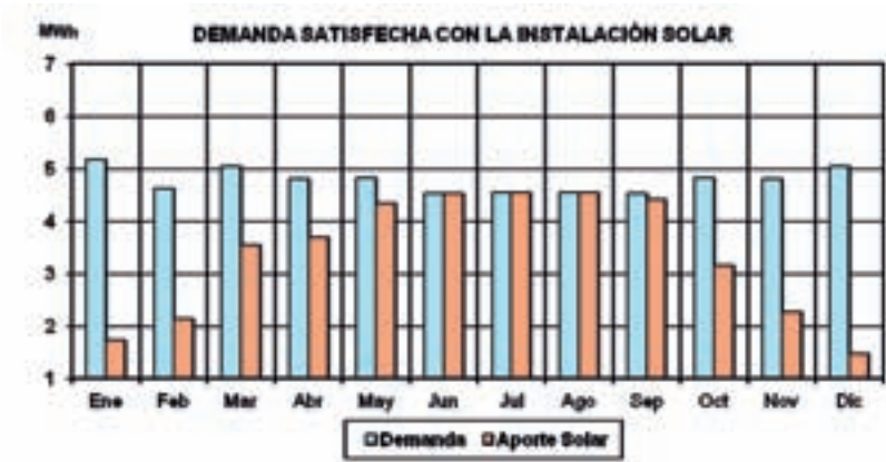
Figura 9.21. Demanda satisfecha con la instalación solar.
